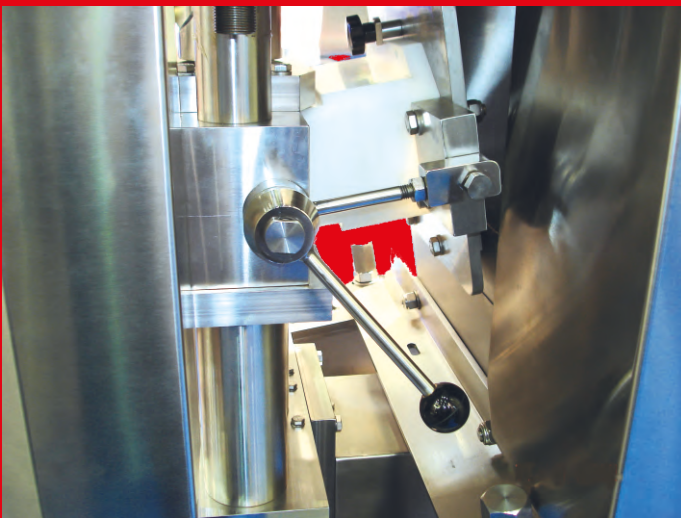
Nur ein Griff zum Öffnen der Maschine One grip only for opening the machine
